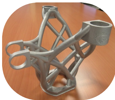
Figure 19 - Pivot reconçu en version tubulaire.
