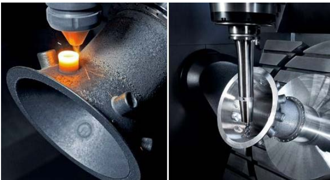
Figure 25 – Machine hybride projection de poudre et usinage conventionnel.
