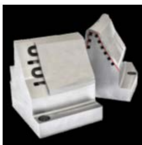
Figure 26 – Outillage : fraisage de canaux de refroidissement suivi par la fabrication additive de la couche de couverture (gauche) - Réduction des efforts lors du bridage : rechargement d'aube de turbine (droite)
