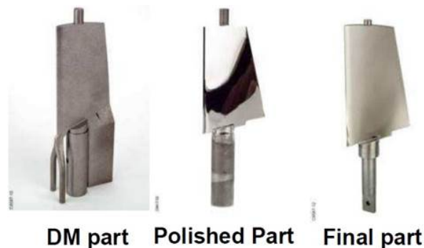
Figure 15- Après fabrication additive, une pièce nécessite des étapes de finition (Source : SNECMA)
