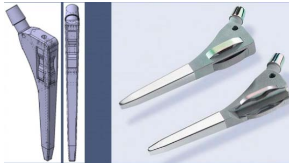
Figure 29 – Tige de prothèse de hanche fabriquée par fusion laser en lit de poudre d’alliage de titane, avec intégration d’un actionneur en tôle d’alliage à mémoire de forme (source : Fraunhofer IWU)
