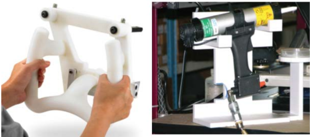
Figure 71 : Exemple d'outillage (fixation, préhenseur) réalisés par impression 3D (Source Strasys)
