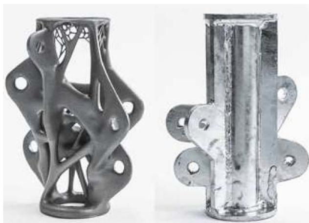
Figure 8 - Exemple de l'optimisation topologique d'une pièce
