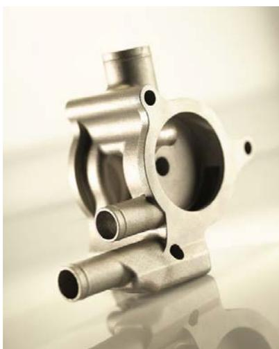
Figure 12 - Carter de pompe à huile - alliage d'aluminium AlSi10Mg : réduction du temps de fabrication, conception optimale en termes de propriétés d'écoulement car il n'y a pas d'arêtes vives dues à des trous de perçage (source Concept Laser).
