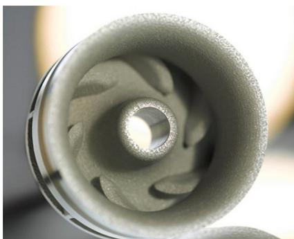
Figure 4 - Roue de pompe à eau pour moteur de sport automobile<sup>14</sup>.
