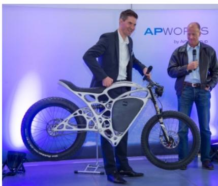
Figure 3 - Exosquelette bionique de moto en Scalmalloy® par fabrication additive<sup>13</sup>.
