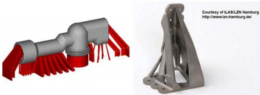
Figure 7 - Pièce non prévue pour de la fabrication additive (à gauche) et pièce prévue pour de la fabrication additive (à droite).
