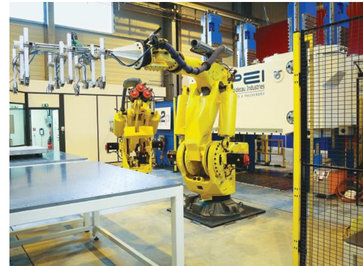
Un premier robot conduit la préforme sur son moule, sous une presse hydraulique.
