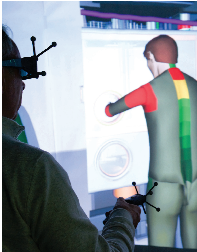
L'avatar reproduit les gestes de l'opérateur et montre les zones du corps sollicitées.
