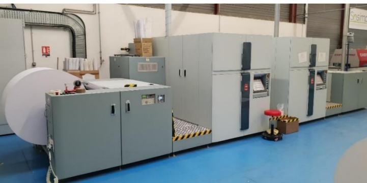
Duplprint : Presse jet d'encre Canon intégrée à une chaîne de finition Tecna 100% automatisée
