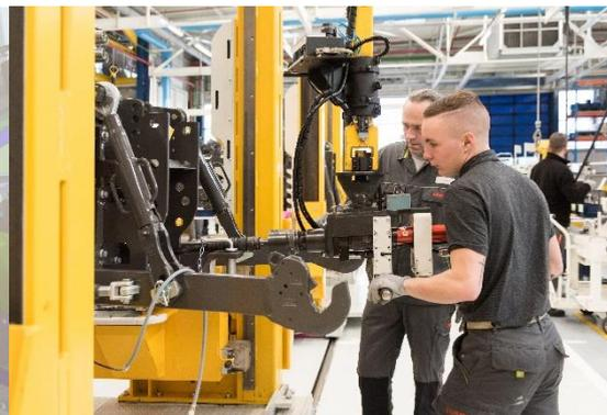
*Solution IOT. Multiplication des visseuses connectées qui permettent de serrer au bon couple, au bon angle en fonction des commandes mais aussi de passer des consignes « qualité ». La formation au poste s'en trouve facilitée.*
